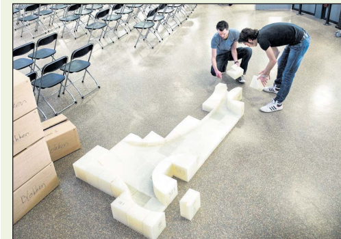
Van de legpuzzel van uitgeprinte vormdelen wordt een mal gemaakt.
