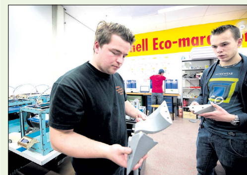
Voor het dashboard worden uitgeprinte kunststofdelen met ouderwetse gat-en-penverbindingen aan elkaar gelijmd.
